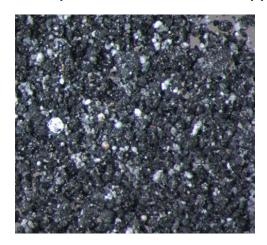
Описание продукции: Мелкозернистый порошок, состоящий из частиц угловатой формы. Концентрат недожога каменного угля, образующиеся при высокотемпературном сжигании каменного угля, и полученный сепарацией после обработки зольных материалов.
